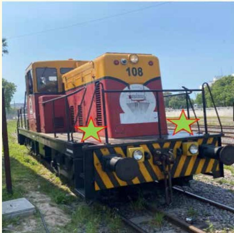
En la imagen se puede observar el tipo de locomotora modelo GE DB 130130- número interno 108 que se conduce y en la siguiente imagen la posición del maquinista.
